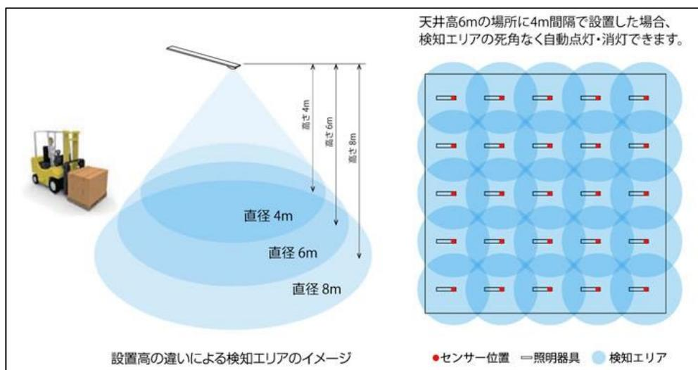
高性能センサーにより、8m の天井に取り付けても、床を移動する人やフォークリフトに反応して自動点灯します
