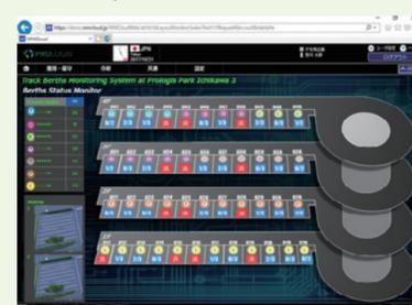
カメラとセンサーを活用した、トラックバースの状況をタイムリーに把握できるクラウドベースのシステムです。入出庫管理、車両識別、設備破損の監視にも活用できます。将来的にはIoT、AIを活用し、物流の更なる最適化を実現します。
