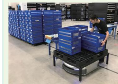
商品のピッキングや商品棚の移動を最適な動きで実現し、作業効率を向上。最新型では周囲の状況に応じて最適なルートを走行する「SLAM方式」を採用し、床面の工事をすることなく、パレット、台車、ラックなどを最大1,000kgまで搬送できるタイプが登場しました。
